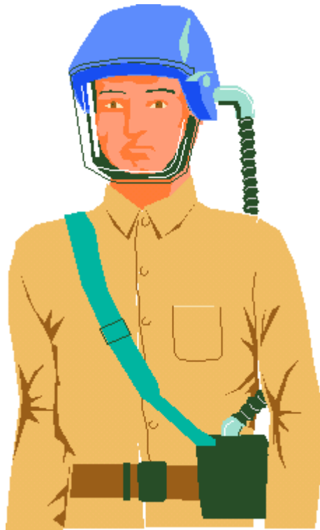
圖 4 使用頭盔式寬鬆面體的動力淨氣式呼吸防護具，繫掛於佩戴者腰部的元件包括電池、送風機與淨氣裝置（湯大同繪）
